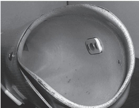
FIGURA 1.3. Encaixe de uma prótese mioelétrica com foco em seu eletrodo.
