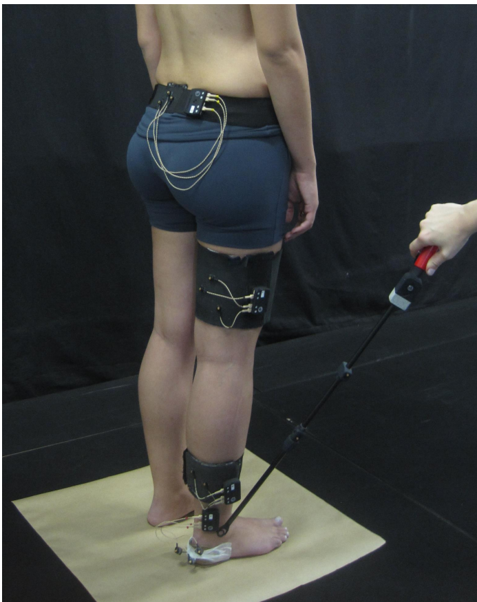
Figura 1 - Clusters com marcas de rastreamento conectadas a baterias para os segmentos coxa, perna, retropé e pelve e pointer para criação das marcas anatômicas virtuais.
