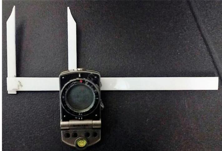
FIGURA 6 . Inclinação digital acoplado ao nível de bolha.
