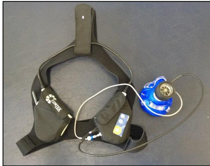
Figura 3. Cortex Metamax 3B inserido no colete, juntamente com a máscara de silicone.
