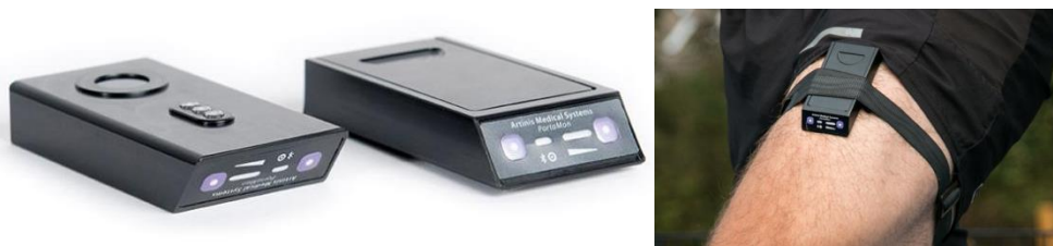
Figura 3. Aparelho PortaMon® fabricado pela Artinis Medical System BV. À esquerda, a visualização do aparelho; à direita, aplicabilidade prática no músculo quadríceps durante caminhada com fixação por faixa. (Adaptado de Artinis Medical Systems ( https://www.artinis.com/portamon )).
