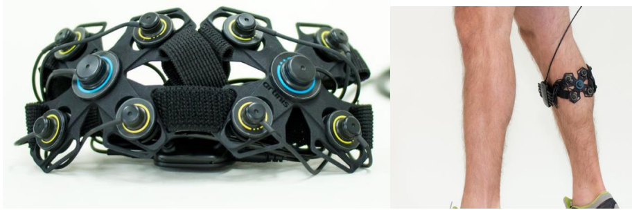
Figura 4. Octamon Muscle® produzido pela Artinis Medical System BV. À esquerda, a visualização do aparelho; à direita, aplicabilidade prática no músculo gastrocnêmio durante caminhada. (Adaptado de Artinis Medical Systems ( https://www.artinis.com/octamon-m ))
