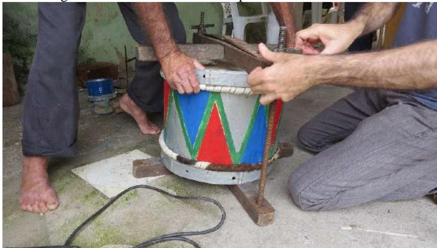
O processo de pensar os arcos e firmar o couro no cilindro, abaulando-o para baixo, exige bastante força. É preciso que o couro ceda o suficiente para que o arco de madeira, também, desça. Assim, quando o couro cede, o arco desce um pouco abaixo da beirada do cilindro. Desta maneira, o aro de Cipó apoia o arco de Pau-de-óleo e ambos abraçam o cilindro. Para que tudo isso aconteça, o artesão se envolve, intensamente, com o tambor esbanjando saúde.
