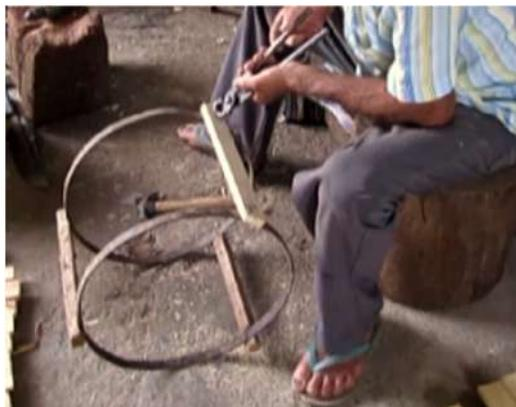
FIG 95. Seu Nego amarrando madeiras nos aros de ferro, sendo três madeiras, duas antigas e uma ripa nova numerada. As duas madeiras antigas têm dois furos para serem amarradas ao aro com um pedaço de arame.
