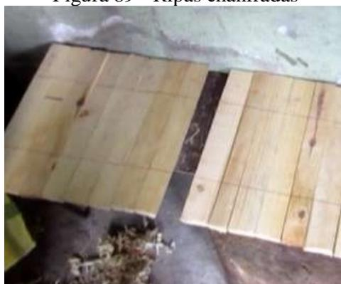
FIG 87. Cada ripa é aparada com uma plaina manual, por meio de um processo conhecido como chanfrar. Fixada na mesa existe uma madeira com duas fendas. Estas têm a função de prender firmemente as ripas enquanto são chanfradas.
