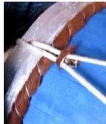
FIG 166. Com uma tira de couro úmida, medindo, aproximadamente, 30 centímetros, o artesão fez um corte horizontal em uma das extremidades da tira. Nas cordas da caixa, justamente, onde se forma o desenho em V, ele inicia a confecção de uma brocha.
