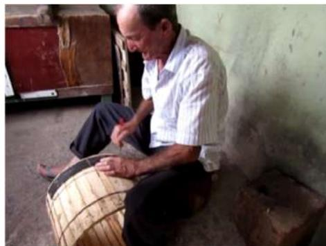
FIG 111. Início do processo para aparar o cilindro. O artesão prende a tira de lona no cilindro usando um prego.
