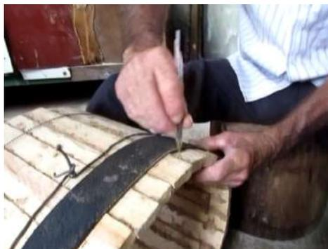
Nas FIGURAS 121 e 122, Seu Nego usa da extremidade que já foi nivelada, como referência, para marcar pontos na extremidade que será aparada. Com a altura do cilindro final já definida (25,5 cm), o artesão faz os pontos no entorno da extremidade que será lavrada. Depois ligamos os pontos marcados no cilindro. Esta linha é a referência para apararmos a extremidade do cilindro. Enquanto trabalhamos, Seu Nego narra como executava esta técnica no início do ofício.
