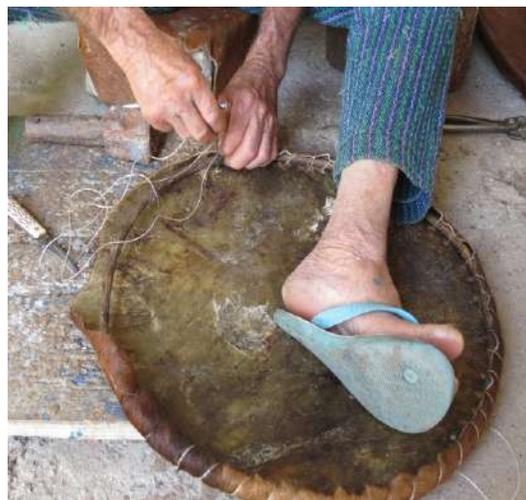
FIG 151 e 152. O primeiro furo feito com o prego, no couro, serve para dar a primeira laçada com um nó bem firme deixando uma sobra de linha. A costura é feita alinhavando o couro por cima do aro. Os furos feitos no couro devem ficar próximos do aro. O segredo é deixar os furos uns 2 cm de distância um do outro e apertar sempre a costura para manter o couro justo ao aro.
