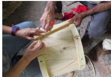
FIG 148. Seu Nego mostrando como fazer as marcações nos arcos. Ele usa um pedaço de couro utilizado como medida para marcar os espaçamentos dos orifícios nos arcos.
