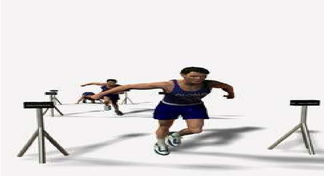
Figura 1. Simulação de percurso usando fotocélulas para registrar o tempo durante os sprints.
