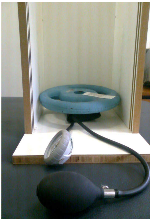
FIGURA 2: Calibração do esfigmomanômetro modificado utilizando anilha de 5kg e aparato de madeira
