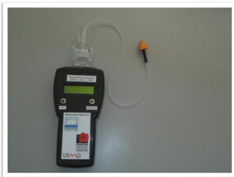
FIGURA 3: Manovacuômetro digital (NEPEB-LabCare/UFMG, Belo Horizonte-MG, Brasil) com o prolongamento de silicone e plugue nasal.
