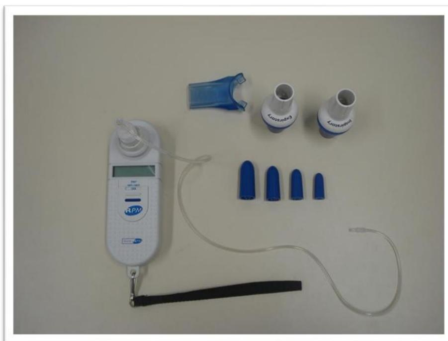
FIGURA 5: Manovacuômetro digital MicroRPM<sup>®</sup> (Micro Medical, Reino Unido).
